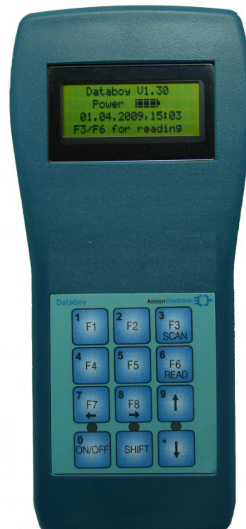
Abb.: Databoy 868MHz und integriertem GPS-Modul – Beispielhafte Darstellung von GPS-Koordinaten im Display
